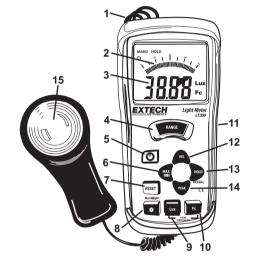
Hinweis: Die Sensor-Schutzkappe ist nicht in der Abbildung dargestellt. Batteriefach, Schwenkstativ und Stativhalterung befinden sich an der Geräterückseite. Der Schutzüberzug muss vom Messgerät entfernt werden, um Zugang zum Batteriefach zu erlangen.
